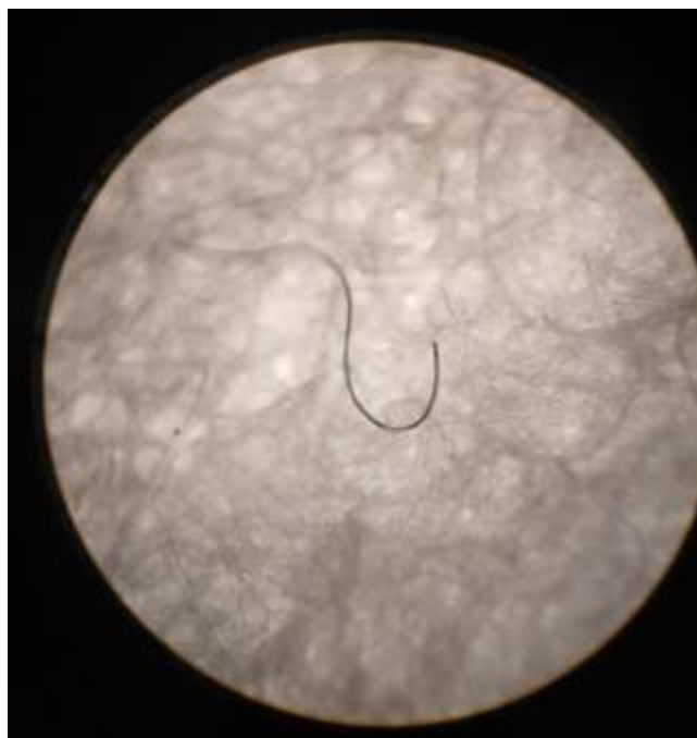
Figura 26. Observación en el microscopio con objetivo 10x de microplástico obtenido en muestra de yogurt batido.
