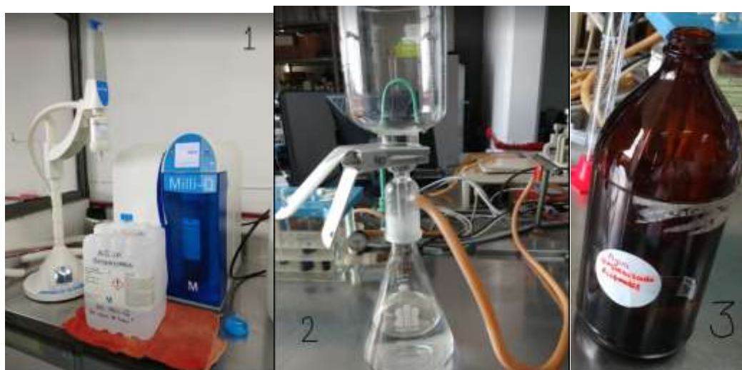
Figura 10. Equipo utilizado para desionizar el agua (1) , equipo utilizado para microfiltrar (2) y envase de resguardo (3).
