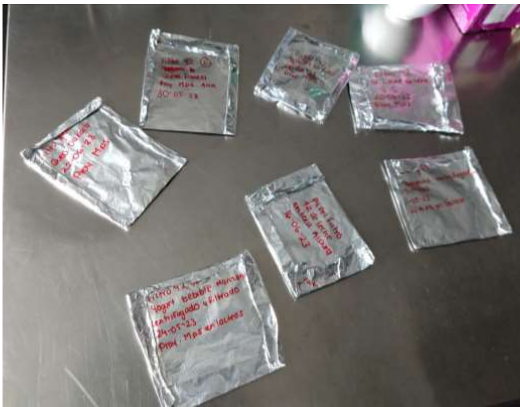
Figura 16. Muestras filtradas en filtros Whatman grado 42 y reservadas dentro de papel aluminio, para su posterior revisión en microscopio.
