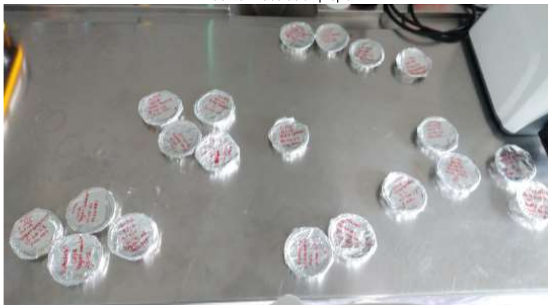
Figura 17. Muestras microfiltradas en microfibras de vidrio GF/A y reservadas en moldes de aluminio con papel aluminio, para su posterior revisión en microscopio.
