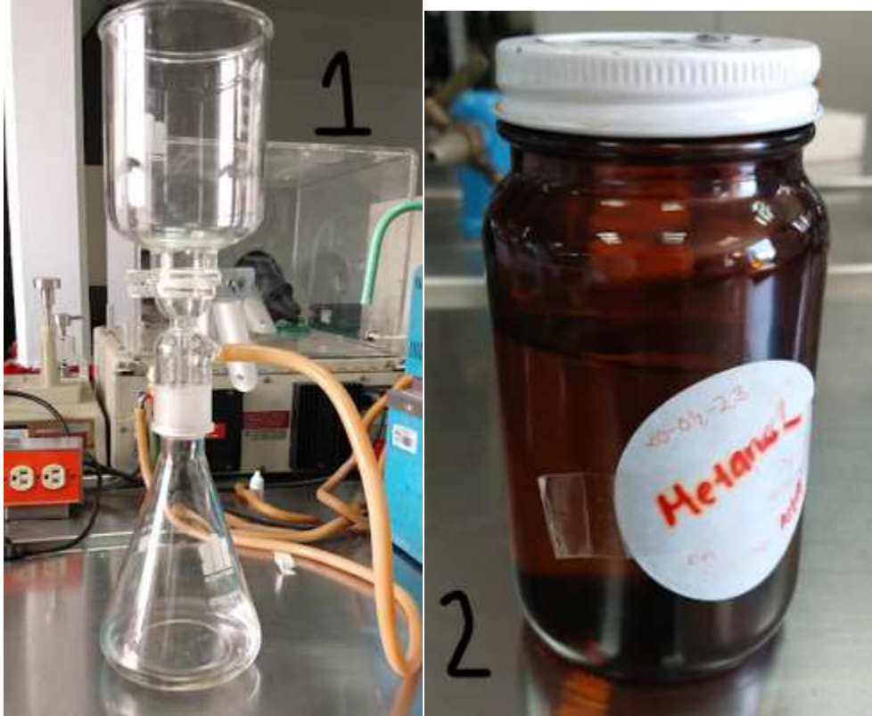
Figura 11. Equipo utilizado para microfiltrar (1) y envase de resguardo (2).
