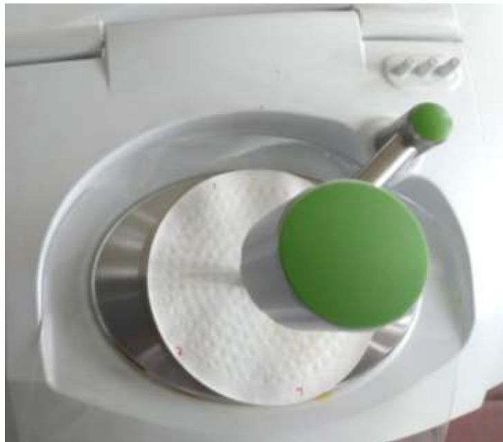
Figura 18. Visualización de membrana Whatman grado 42 mediante técnica de ATR.
