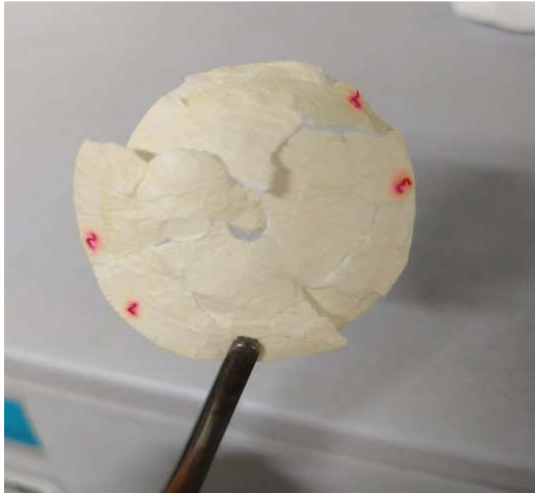
Figura 22. Rotura de la membrana GF/A.
